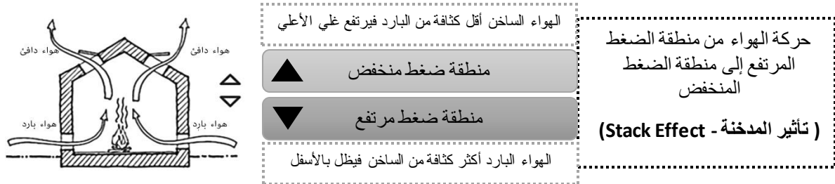
شكل ١٤ يوضح كيفية حركة الهواء ودور التشكيل الهندسي للفراغات في تلك العملية (ZAKI 2022, 48)
