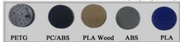
شكل يوضح العينات المستخدمة في اختبار مقاومة التآكل
