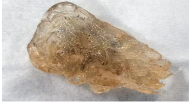
شكل (٤) يوضح تشتت المواد متجانس بعد إضافة زيت البرافين لهم
