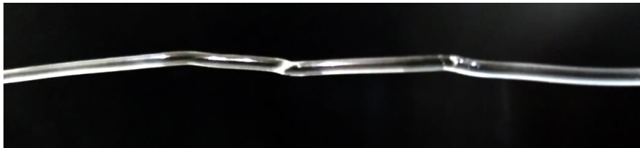
شكل (٧) يوضح عدم انتظام سمك خيوط البلاستيك
