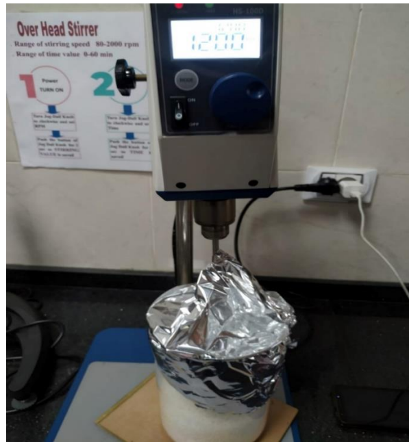
شكل (٥) يوضح جهاز الخلط الكهربائي Electric Overhead Stirrer
