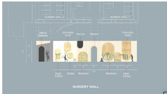
شكل (11) يوضح التفاصيل الخاصة بالمعالجات الخاصة بالجدار السابق من حيث المعطيات المعمارية والمقاسات.
