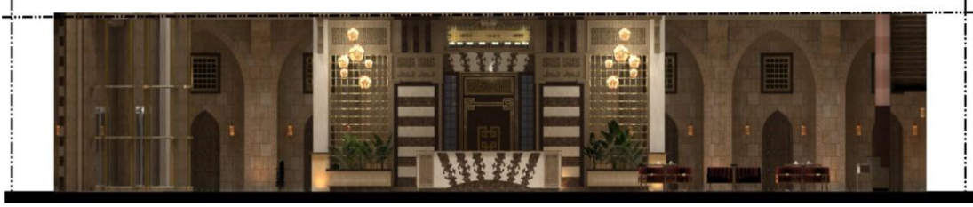
(شكل ٢٤ ب) قطاع رأسى (أ-أ) يمر بمنطقة الفناء الداخلى و يوضح تصميم الكاونتر. المصدر الباحثة.
