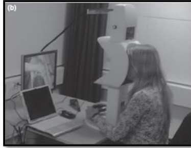
شكل (٣) جهاز تعقب حركة العين المحمول والمثبت على مسند الرأس
