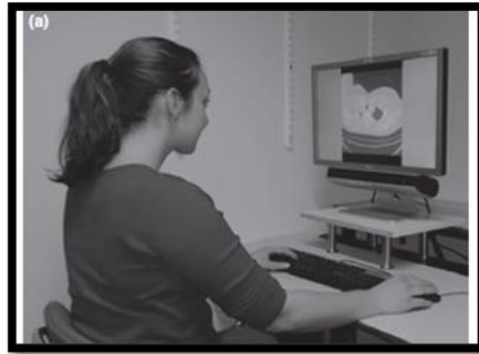
شكل (٢) نظام الشاشة المثبتة لتتبع حركة العين
