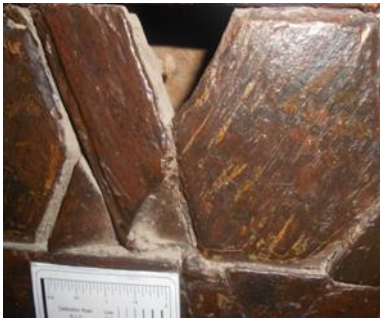
شكل (4) توضيح فقد في إحدى الحشوات
