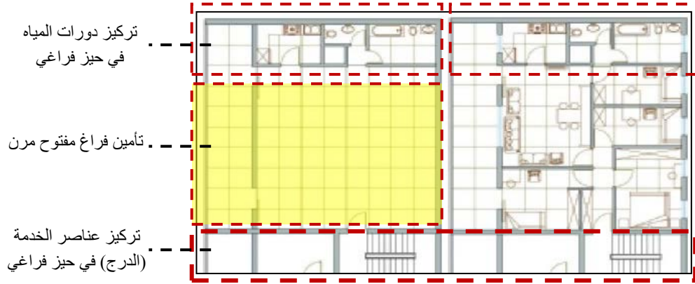
شكل (٤). تثبيت عناصر الخدمة مع خلق فراغ مفتوح يخضع لشبكة مديولية تسهل تقسيمه المصدر (١٠)
