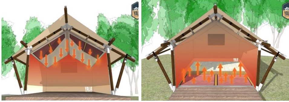
شكل (21) تقنية التدفئة بالأشعة تحت الحمراء يمكن تثبيتها بالأرضية أو بسقف الخيمة لتوزيع الحرارة بالتساوي
