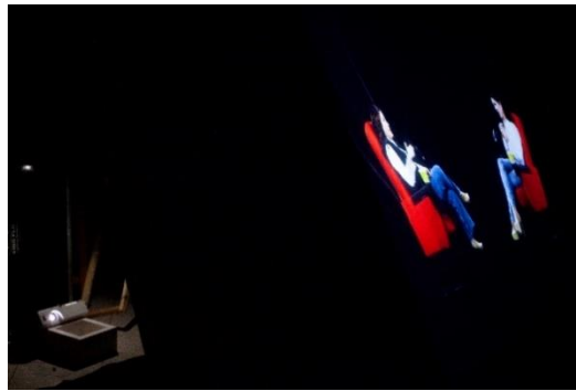
صورة رقم (٢١) توضح وضع البروجيكتور بزاوية ٤٥ خلف اسفل منتصف الجسم الشفاف
