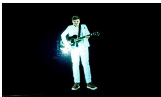
صورة (٢٠) توضح جودة الهولوجرام الناتج مع استخدام البروجيكتور بزاوية عمودية خلف منتصف الجسم النصف شفاف
