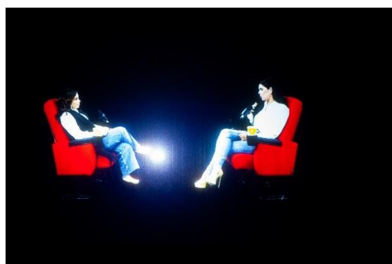
صورة (٢٠) توضح جودة الهولوجرام الناتج مع استخدام البروجيكتور بزاوية عمودية خلف منتصف الجسم النصف شفاف
