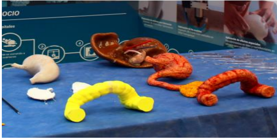
شكل ٧ : يوضح الأجهزة المصنوعة من الطباعة ثلاثية الأبعاد للنماذج والقوالب ، والنسخ باستخدام السيليكون
