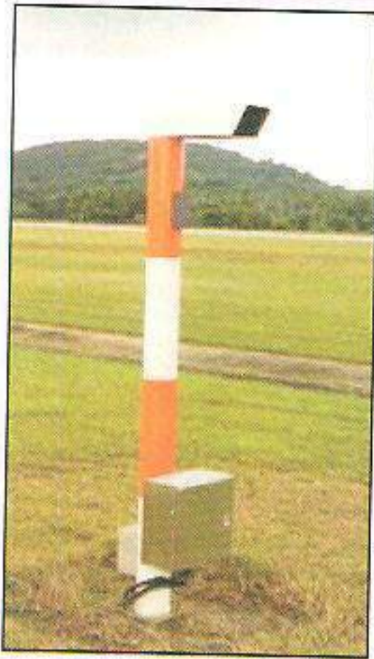
الشكل رقم (٦) يوضح وحدة قياس مدى الرؤية الأفقية على الممر.
