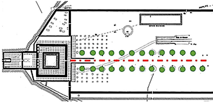
شكل ١٣: مسقط أفقي لمعبد منتوحتب الثاني بالدير البحري يوضح تأكيد صفين من أشجار الجميز لمحور المعبد نقلا عن: (Arnold, 1979)
