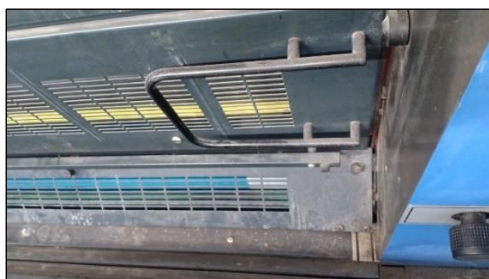
شكل(7) وحدة الورنشة والسطح المسنول على نقل الورنشة الى الاماكن المخصصة
