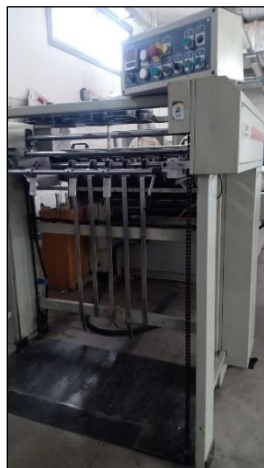
شكل(5) وحدة التغذية فى ماكينه الورنشة
