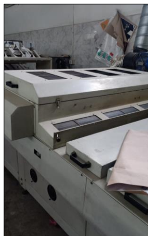
شكل(8) وحدة تجفيف الـ LED UV
