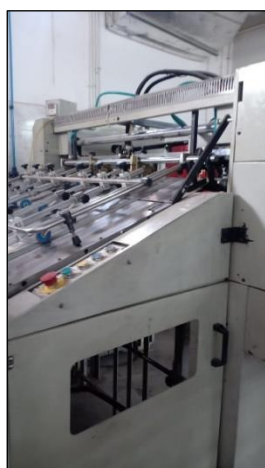
شكل(6) وحدة التسليم فى ماكينه الورنشة
