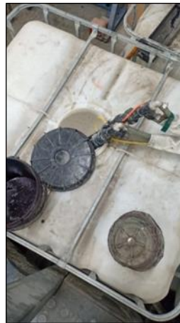
شكل(14) سحب الورنيش المائى على ماكينه الطباعة لاعطاء تغطيه بالورنيش المائى
