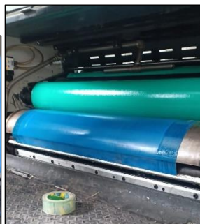
شكل(7) وحدة الورنشة والسطح المسنول على نقل الورنشة الى الاماكن المخصصة
