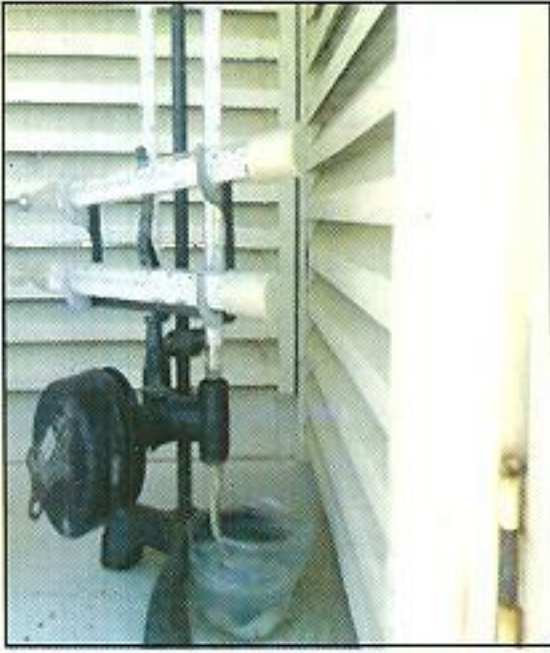
الشكل رقم (٤) ترمومترات النهاية الصغرى والعظمى مثبتة أفقياً مع ميل قليل لترموتر العظمى باتجاه الخزان، أما الترمومتران الجاف والمبلل فمثبتان عمودياً.
