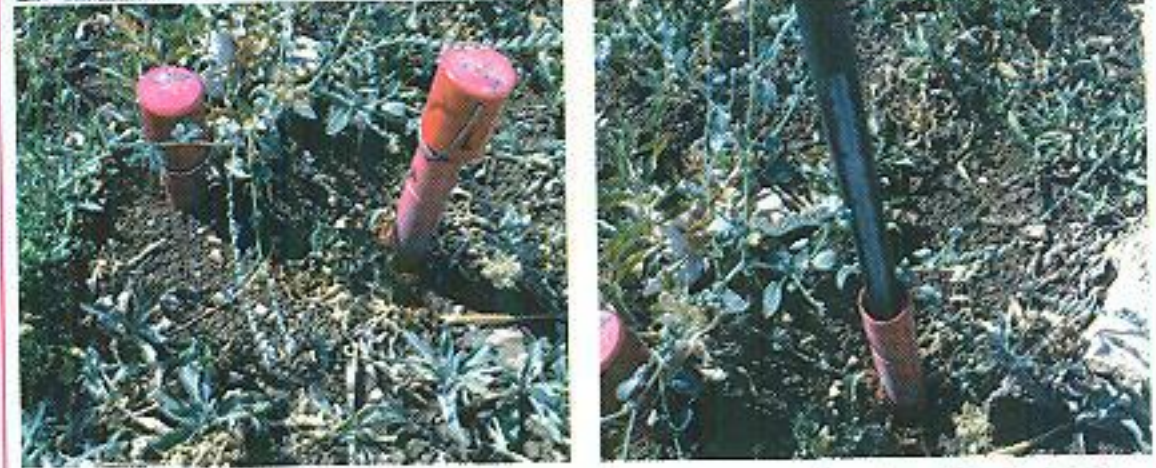
الشكل رقم (٦) يوضح الترمومترات الأرضية على أعماق ٥ سم وحتى ثلاثة أمتار
