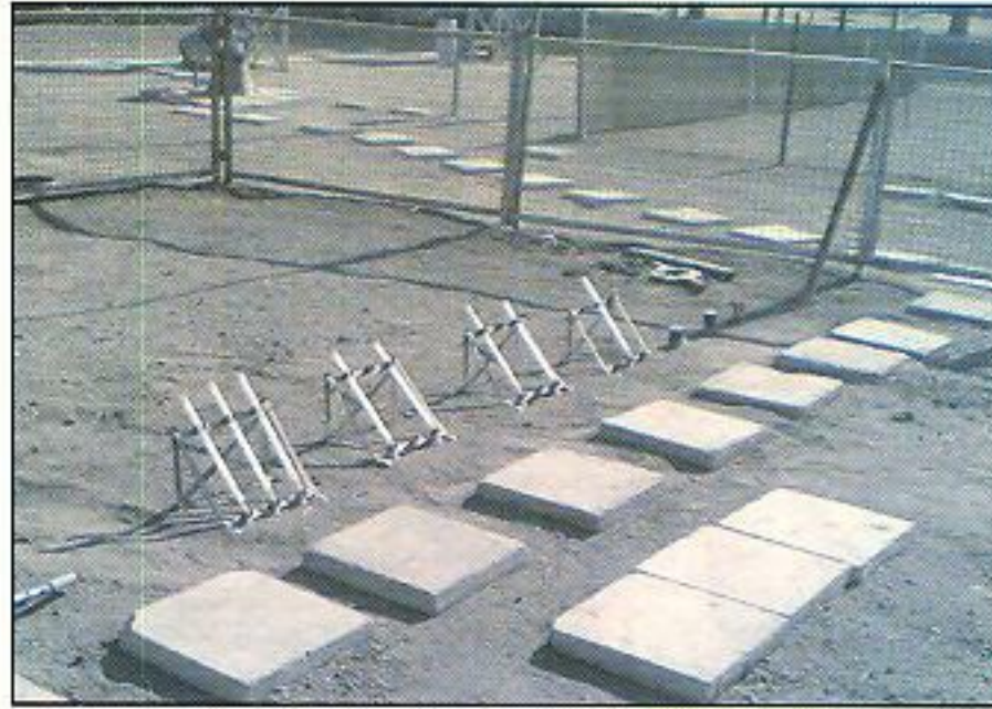
الشكل رقم (١٧) وهو يمثل ترمومترا لقياس درجة حرارة التربة من ٥ سم حتى ٣ أمتار في حقل جاف
