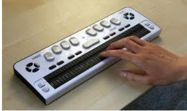
البلاستيكية أو المعدنية، ويتم التحكم في هذه النقاط بواسطة الكمبيوتر وتتحرك للأعلى أو للأسفل لتعرض بلغة الحروف التي تظهر على شاشة الكمبيوتر، وعادة ما يُوضع هذا الجهاز بجانب لوحة مفاتيح الكمبيوتر حيث يُمكن المكفوف من قراءة بلغة برايل .
