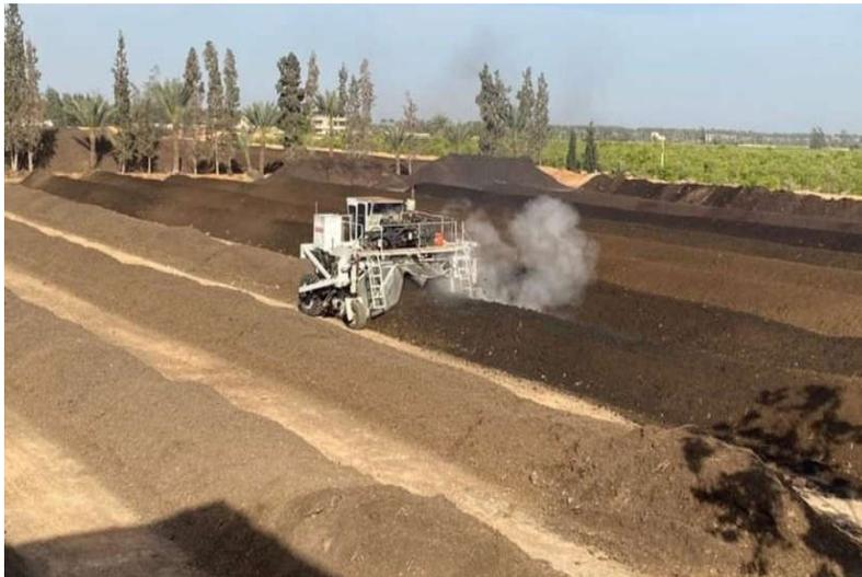
صورة (٤) مكيئة تقوم بعملية تقليب، ورش الكومة بالماء لترطيب كومة الكمبوست لخلطها جيدا مما يساعد على تجانس مكونات الكمبوست مصنع سماد الصالح بمدينة الصالحية بالشرقية ١٠/١٠/٢٣ / ٢٠٢٣
