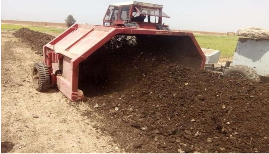
صورة (٣) مكيئة تقليب كومة الكمبوست لخلطها جيدا مما يساعد على تجانس مكوناتها وخفض درجة حرارتها الناتجة عن تحلل المخلفات الزراعية بمصنع قنديل بوادي النطرون بالبحيرة ١٥/١٠/٢٣ / ٢٠٢٣
