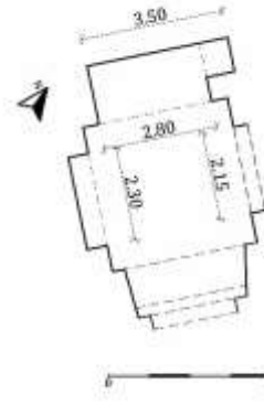
شكل (٢٠) مضاھية مستطيلة بالجدار الجنوبي الغربي بدركاة مدخل مدرسة وخانقاة الظاهر برقوق، عمل الباحثة
