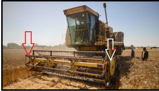
شكل ( ٨ ) يوضح تهيئة مولدات للطاقة فى ماكينة حصاد القمح كما تشير الأسهم*.
