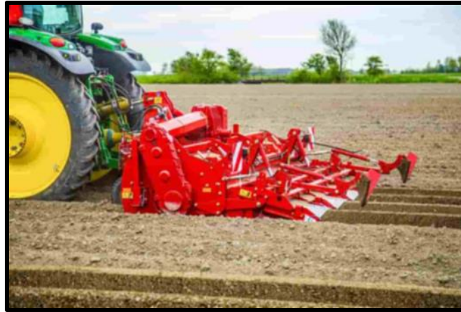
شكل (٢) يوضح ماكينة التسوية و الحرث للأرض الزراعيه الملحقه بالجرار الزراعى
