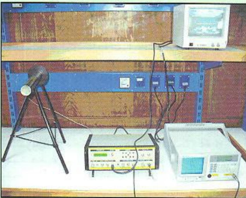
الاجزاء الثلاثة المنفصلة المكونة لمعمل الاتصالات بالأقمار الصناعية وهي على الترتيب القمر الصناعي ثم وحدة الإرسال فوحدة الاستقبال
