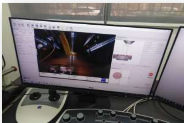
صور أرقام (٧) ، (٨) للميكروسكوب الإلكتروني الماسح موديل ZASS – EVO 10 و المرفق به وحدة ال EDX
