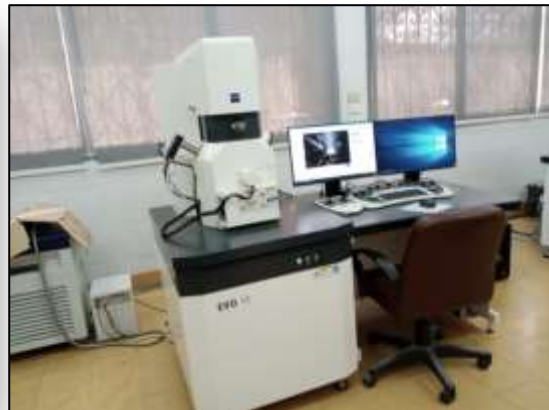
صور أرقام (٧) ، (٨) للميكروسكوب الإلكتروني الماسح موديل ZASS – EVO 10 و المرفق به وحدة ال EDX
