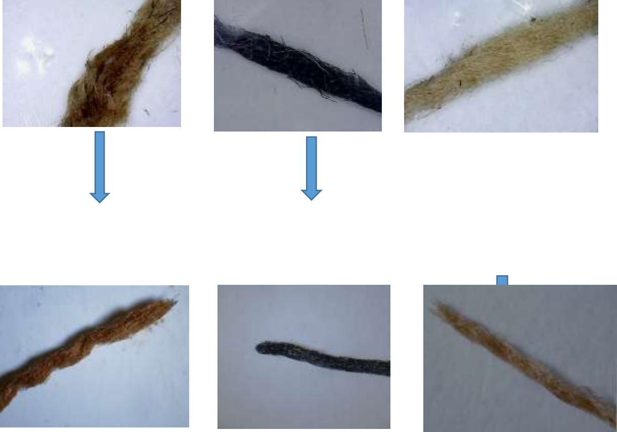
عينات الياف قبل وبعد التقويه بالكلوسيل جي
