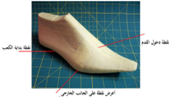
صورة رقم (20) تحديد نقاط الحركة الأساسية على القالب للتصميم رقم (3)
