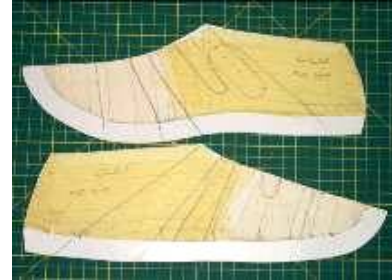
صورة رقم (7) استخراج اسطمية الجانب الداخلي والخارجي للتصميم رقم (1)
