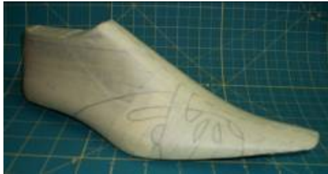
صورة رقم (21) رسم خطوط التصميم على القالب للتصميم رقم (3)
