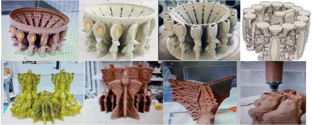
شكل رقم (٦) مراحل طباعة أشكال خزفية ثلاثية الأبعاد لأشكال مصممة بالنكاء الاصطناعي
