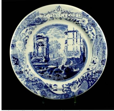
شكل (3) من أشهر ألوان الطباعة لديكال اللون الواحد هي طباعة الكوبلت بماكينه (Murray Curvex) بطريقة (intaglio)
