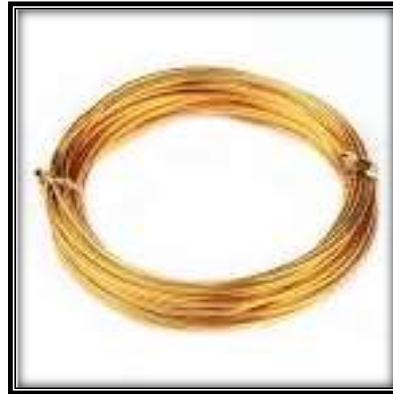
صورة (٥) السلك النحاسي ذو قطر (١,٥ مم) المستخدم في تنفيذ عينة البحث
