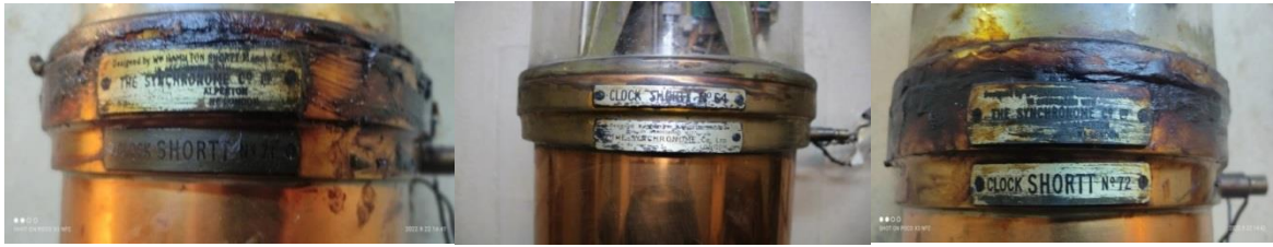
(لوحات ٨-٩-١٠) أرقام التسلسلية لساعات شورت المتزامنة الرئيسية على الناقوس النحاسي والختم الشمعي المحكم الإغلاق الموجود أعلاها مباشرة © عمل الباحث .
