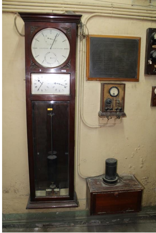
(لوحة ١٣) ساعة الوحدة المتزامنة الثانوية وبجوارها وحدة تحويل الطاقة الكهربائية إلى الكهرومغناطيسية © عمل الباحث.
