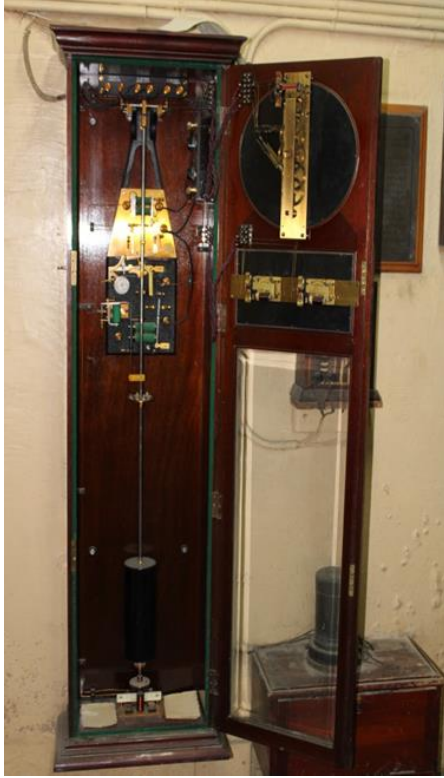
(لوحة ١٤) داخل ساعة الوحدة المتزامنة الثانوية ومحتواها الكهروميكانيكية © عمل الباحث
