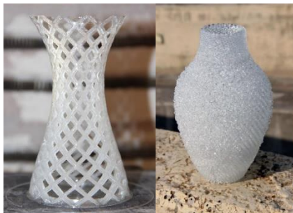
صورة (١٢) مجموعة من المنتجات الزجاجية المنفذة بتقنية بثق المصهور عبر الطباعة ثلاثية الأبعاد (John , 2015)
