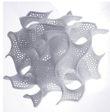
صورة (٢) أشكال زجاجية ذات تصميم معقد منفضة باستخدام طباعة ExOne ثلاثية الأبعاد (Susanne, 2012)
