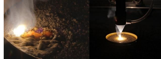
صورة (٤) عملية إنتاج الزجاج من خلال تقنية التلييد الانتقائي بالليزر (Jenny, 2016)
