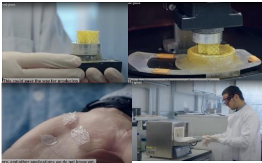
صورة (١٨) إنتاج الزجاج باستخدام الطباعة ثلاثية الأبعاد "ستيريوليثجرافي" (David, 2019)
