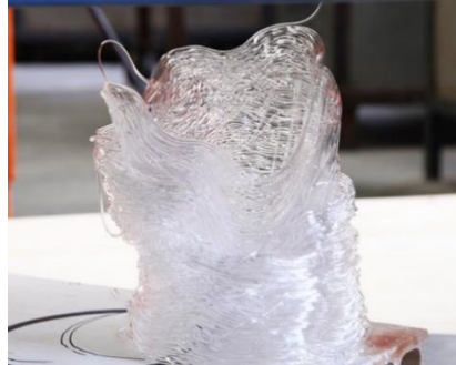
صورة (٨) مراحل طباعة الزجاج بتقنية الطباعة ثلاثية الأبعاد عبر نمذجة الترسيب المنصهر (Stefanie, 2017)
