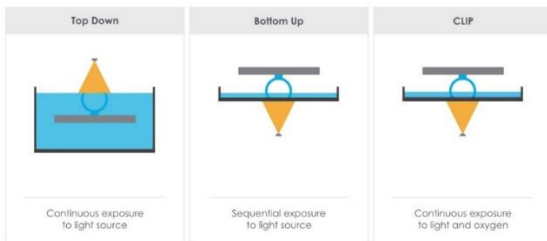
شكل (٦) أنماط اتجاهات طرق التشكيل في الطباعة ثلاثية الأبعاد - Frey (2017)
