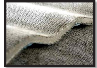
شكل (١٥): طبقات خامة القماش الخرساني.
