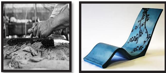
شكل (١٤): الأثاث المصنوع من قوالب الخرسانة المدعمة بالألياف الزجاجية.
