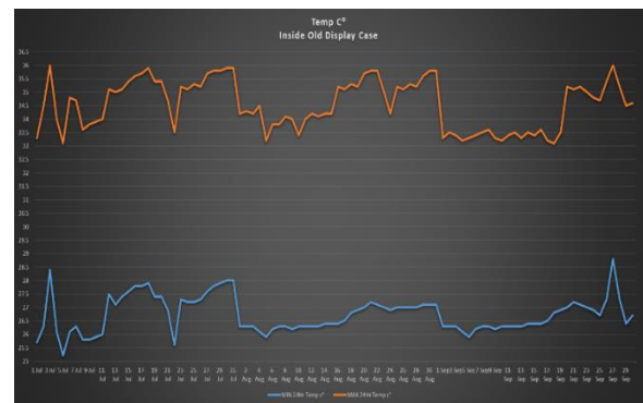
شكل رقم (2) الرصد البيئي (لدرجات الحرارة) داخل وحدة العرض موضع الدراسة (وحدة عرض لمجموعة توابيت حاملة للطبقات اللونية).
