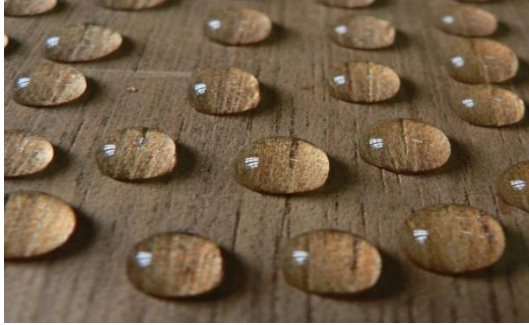
صورة رقم (8) المظهر المميز لسطح الخشب المعالج بالنانو المقاوم للماء (نقلًا عن NanoPhos SA، اليونان)
