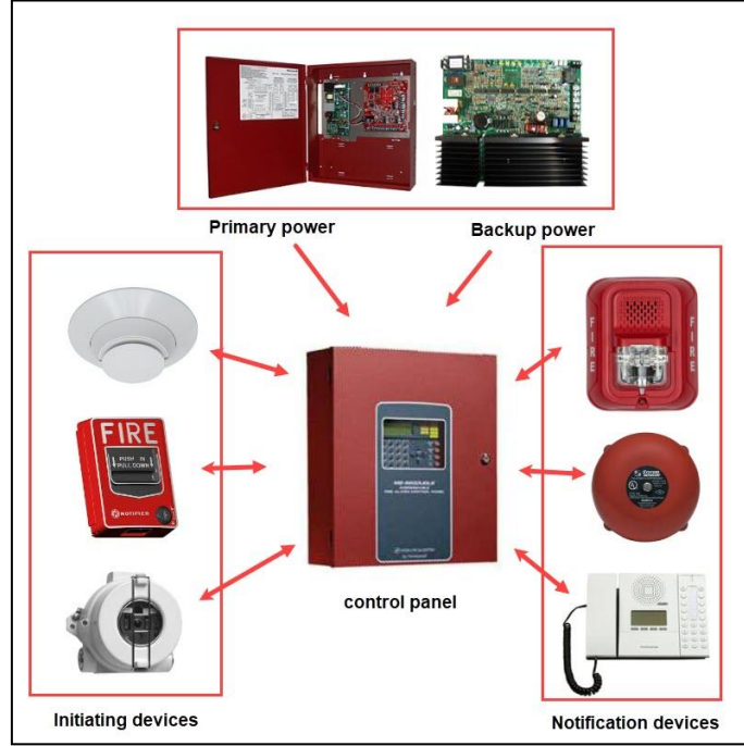
شكل (٤) يوضح أحدث أجهزة الإنذار الآلية لكشف الدخان والحرائق.
