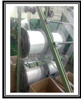
شكل (٢) حامل مطواة السداء الخلفية شكل (٣) خيوط السداء وهى تمر بالمشط الخلفى شكل (٤) حامل خيوط اللحمة
