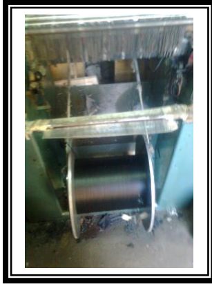
شكل (٦) حامل خيوط اللحمه الخلفى شكل (٧) أشرطة الجومة قبل دخولها المشط لتوزيعها شكل (٨) مطواه خيط السداء ٢- الخامه المستخدمة (القماش):
