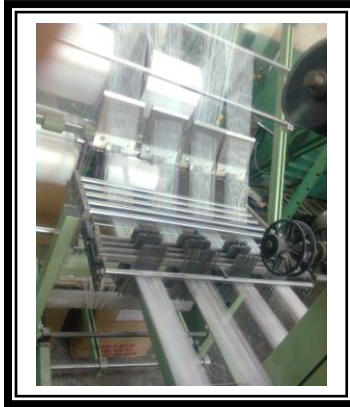
شكل (٢) حامل مطواة السداء الخلفية شكل (٣) خيوط السداء وهى تمر بالمشط الخلفى شكل (٤) حامل خيوط اللحمة
