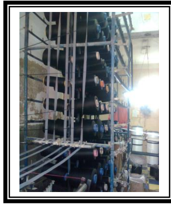
شكل (٦) حامل خيوط اللحمه الخلفى شكل (٧) أشرطة الجومة قبل دخولها المشط لتوزيعها شكل (٨) مطواه خيط السداء ٢- الخامه المستخدمة (القماش):
