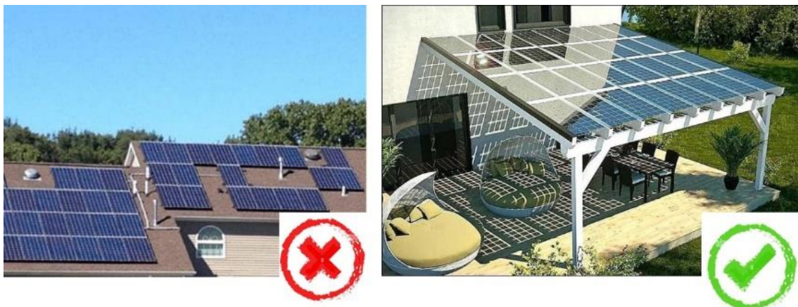
شكل ١: نموذج "تكامل / عدم تكامل" تصميم الخلايا الفوتو فولتية مع العناصر المعمارية للمبنى، المصدر: الباحث.
