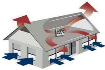
شكل (32) الهيكل البنائي للتصميم المعماري للاستفادة من التهوية السلبية في بيئة العمل.
