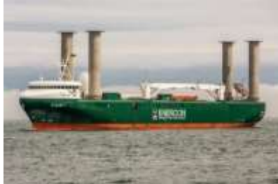
شكل (12) يوضح مفهوم تصميم السفينة الدوارة و سفينة (E-Ship 1) مُثبت عليها دوارات فليتنتر. /https://oceaninfo.com/exploration/sailing/magnus-effect
