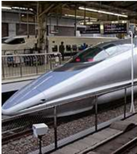
شكل (1) يوضح تصميم (nosecone) المستلهم من طائر الرفراف لقطار الطلقة الياباني.
