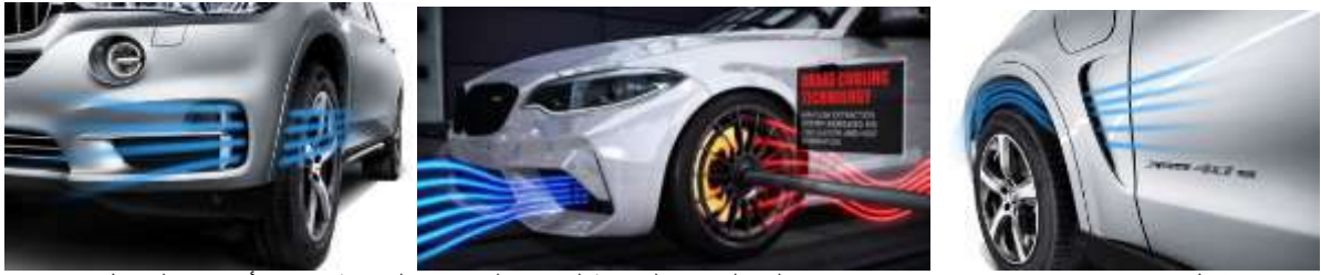
شكل (29) يوضح استخدام سيارات بي ام دبليو الستارة الهوائية لتعزيز الديناميكا الهوائية وتبريد أقراص الفرامل.
