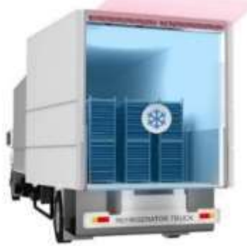
شكل (28) استخدام باب هواء الشاحنات (Airtrack) علي الشاحنات المبردة.
