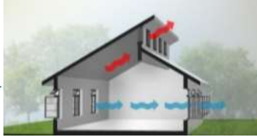
شكل (32) الهيكل البنائي للتصميم المعماري للاستفادة من التهوية السلبية في بيئة العمل.
