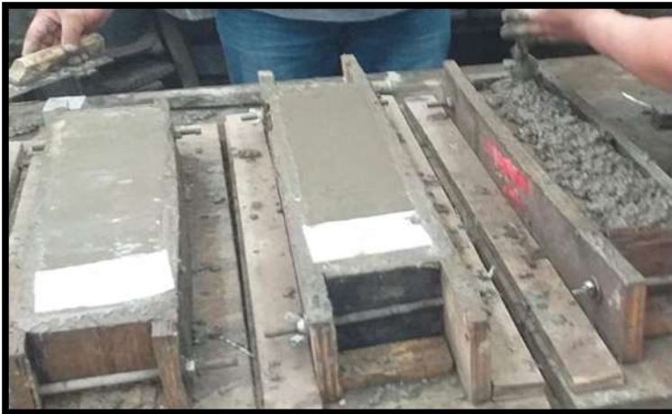
صورة (1) طريقة صب الخرسانة في القوالب الحديدية
