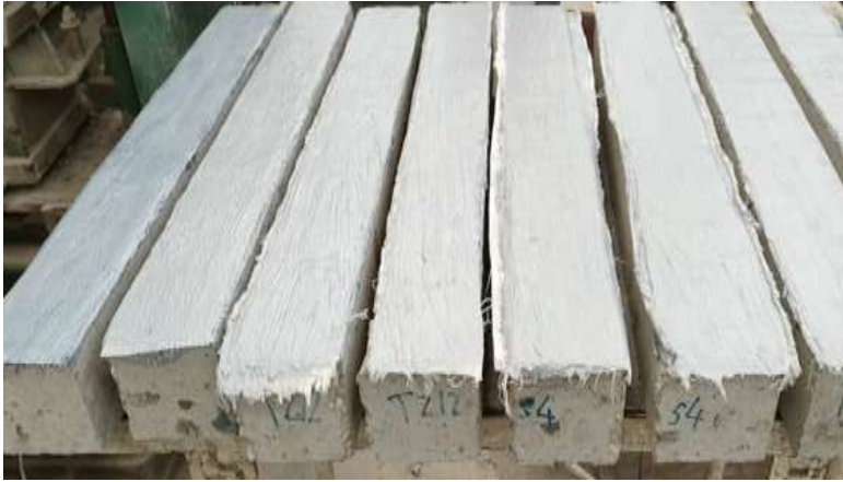
صورة (3) توضح طريقة تقوية الكمرات الخرسانية بالأقمشة
