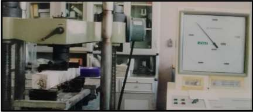
صورة (4) يوضح كيفية اختبار الكمرات القياسية باستخدام ماكينة شيمدزو
