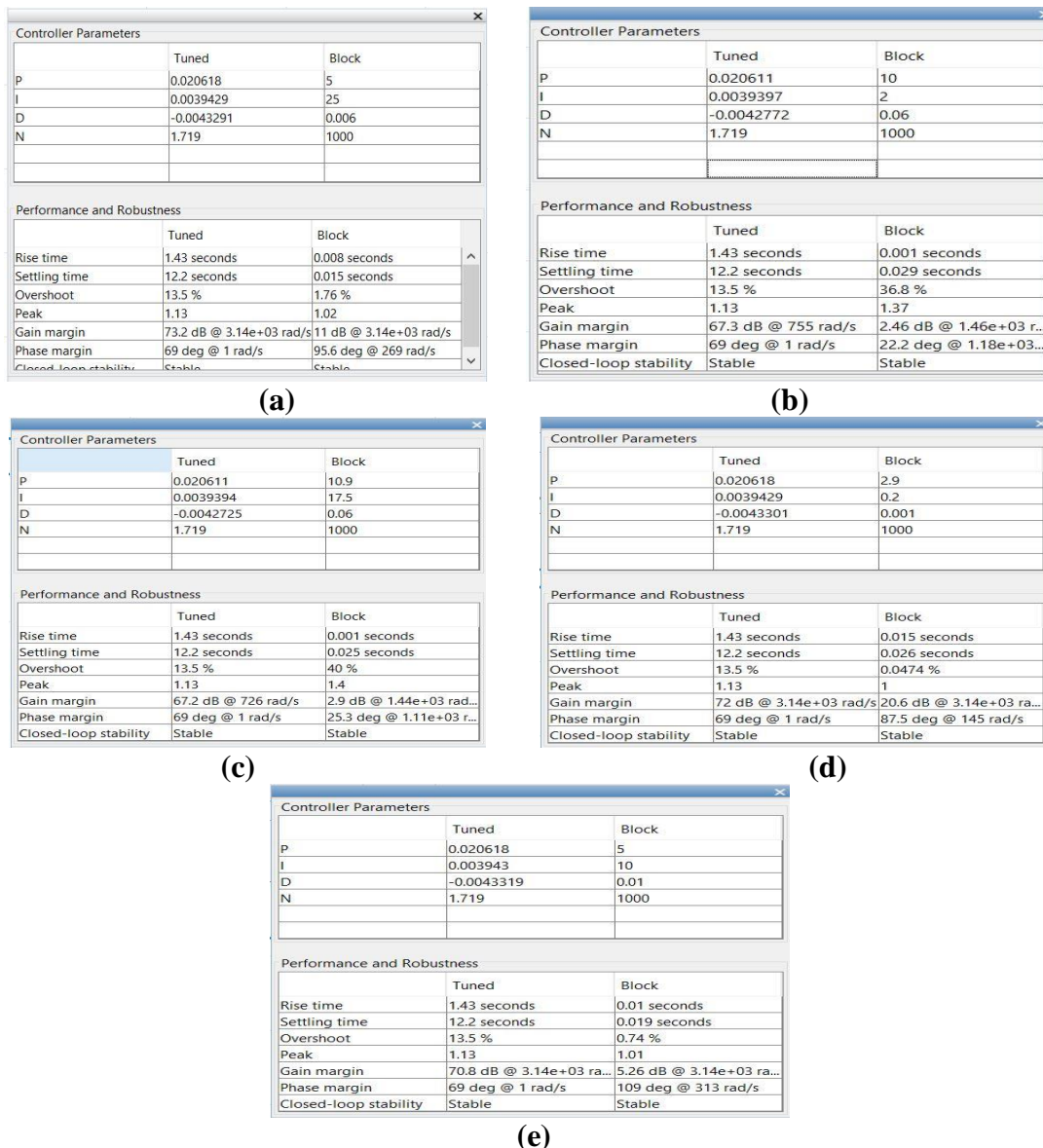
Fig. 14 Controller parameters of: (a) PID1, (b) PID2, (c) PID3, (d) PID4, and (e) PID5.
