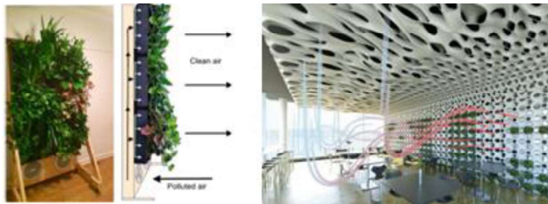
شكل (9): نظام الجدار النشط المصدر: Pettit, T., Irga, P. J., & Torpy, F. R. (2019).
