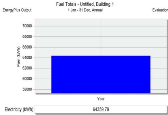
رسم بياني (١٨) الاستهلاك السنوي للوقود قبل تعديل المبني السكني المصدر: برنامج المحاكاة Design builder
