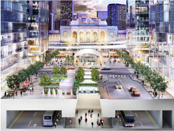
شكل 18: قطاع عرضي بمحور المشاة، توفر الإضاءة الطبيعية للدور السفلي. [26]
