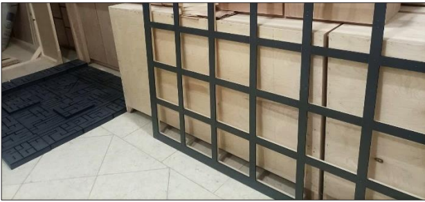
شكل (١٢) قطع ألواح خشب (Mdf) تبعًا للتصميم المُحدد بواسطة ماكينات الليزر "Laser cutting" (المصدر: الباحثة).
