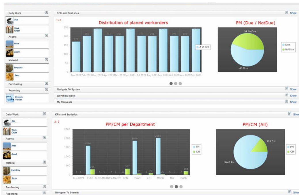
شكل ٨: قياس مؤشرات أداء التشغيل والصيانة KPIs عبر تطبيق CMMS (المصدر: شركة EMC).
