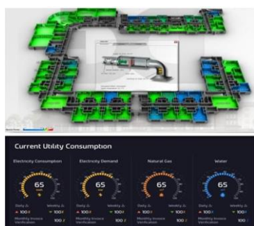
شكل ٢١: مراقبة عمل أنظمة التشغيل عبر تطبيق التوائم الرقمي DT لمستشفى شانجهاى.
