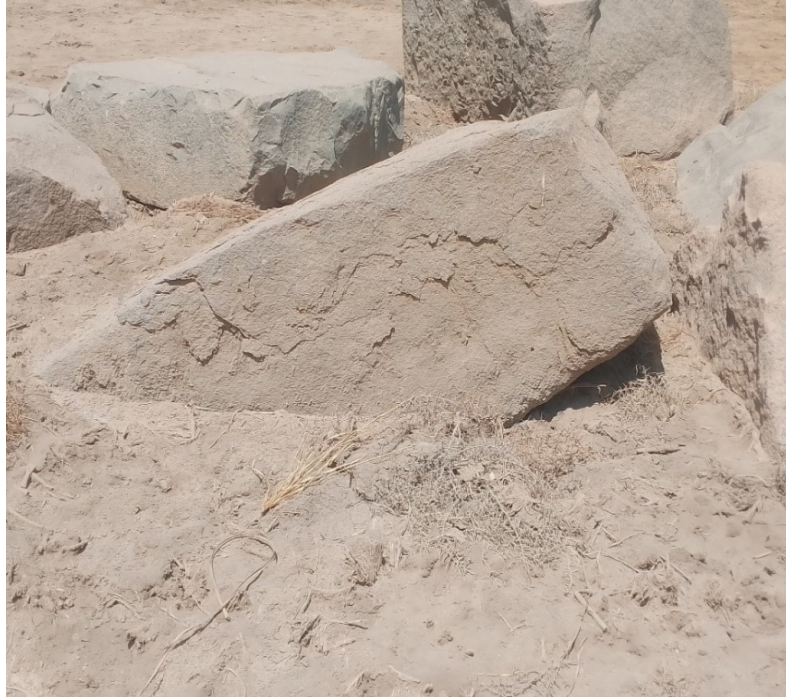
لوحة رقم (٤) تفتت الكتل الحجرية بفعل المياه الأرضية (تصوير الباحث)
