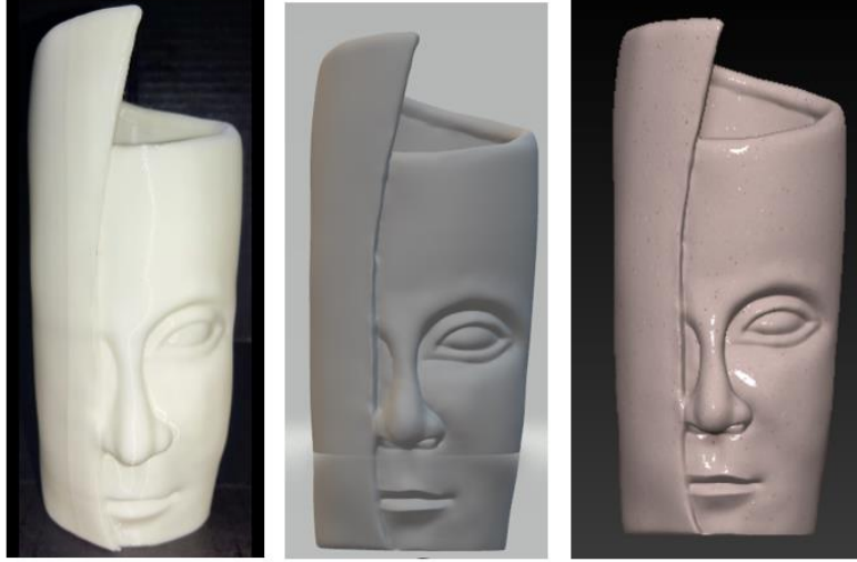
شكل (٧) نموذج نحتي وظيفي صمم على ZBrush ، وتمت معاينته بصيغة STL قبل تنفيذه بطابعة FDM بخامة PLA Plus
