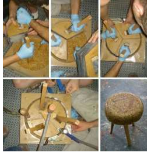
شكل (١٤) يوضح خطوات تنفيذ مقعد نشارة الخشب 1
