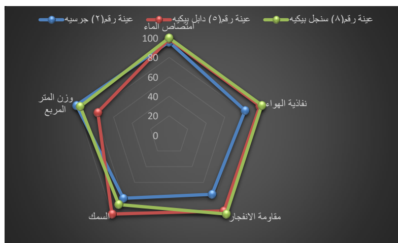
شكل (23) الشكل الراداري لنتائج اختبارات العينات رقم (٨، ٥، ٢)
