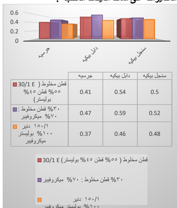
شكل (١٥) متوسط نتائج اختبار قياس السمك لكل تركيب بنائي
