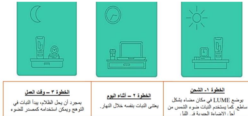
شكل ( 4 ) يوضح الخطوات الروتين اليومي لوحدة الإضاءة الليلية لوما LUMA
