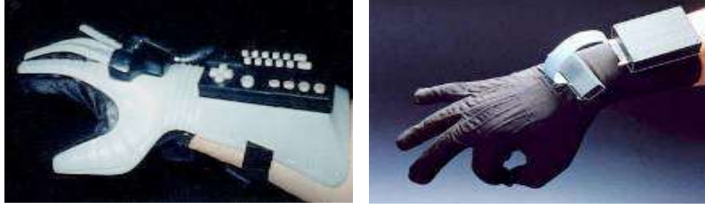
الشكل رقم (٤) أنواع مختلفة من قفازات البيانات تسمح بالتحكم والقبض والإحساس بالملمس دور الإنفوميديا في دعم وتنمية هذه المهارات :
