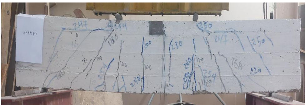
(d) – Failure of B04
